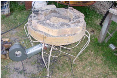
Fragua funcionando con aireador y coque, capaz de fundir hierro a crisol abierto
