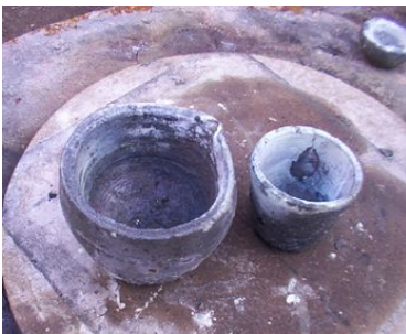
Crisoles de grafito realizados en el torno. No son sometidos a compresión.
